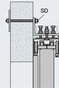
Nur in Verbindung mit einem Stahlbetonsturz gemäß statischem Nachweis. Der Sturz ist entsprechend der Laufschienenlänge über den Toröffnungsbereich hinaus zu führen.
