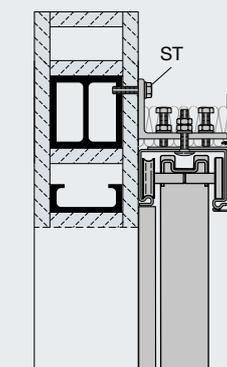
Bekleidete Stahlstützen und / oder -träger mindestens der Feuerwiderstandsklasse F90, Kurzbezeichnung F90-A nach DIN 4102-4.
