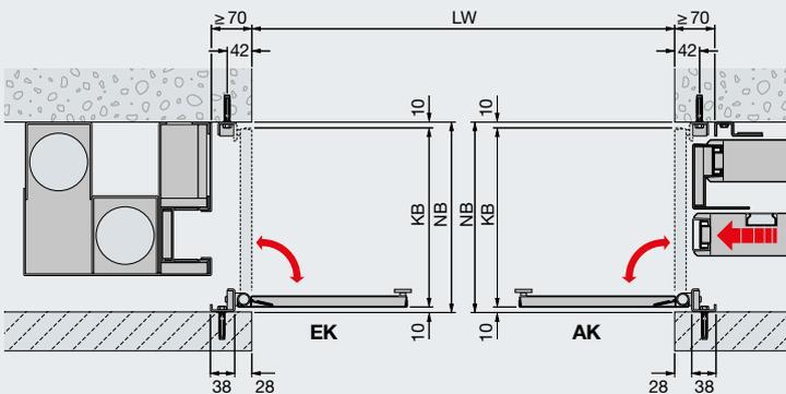
**Deckenklappen für den Sturzbereich**
