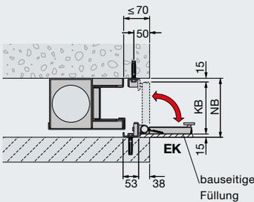
**Deckenklappen für den Sturzbereich**
